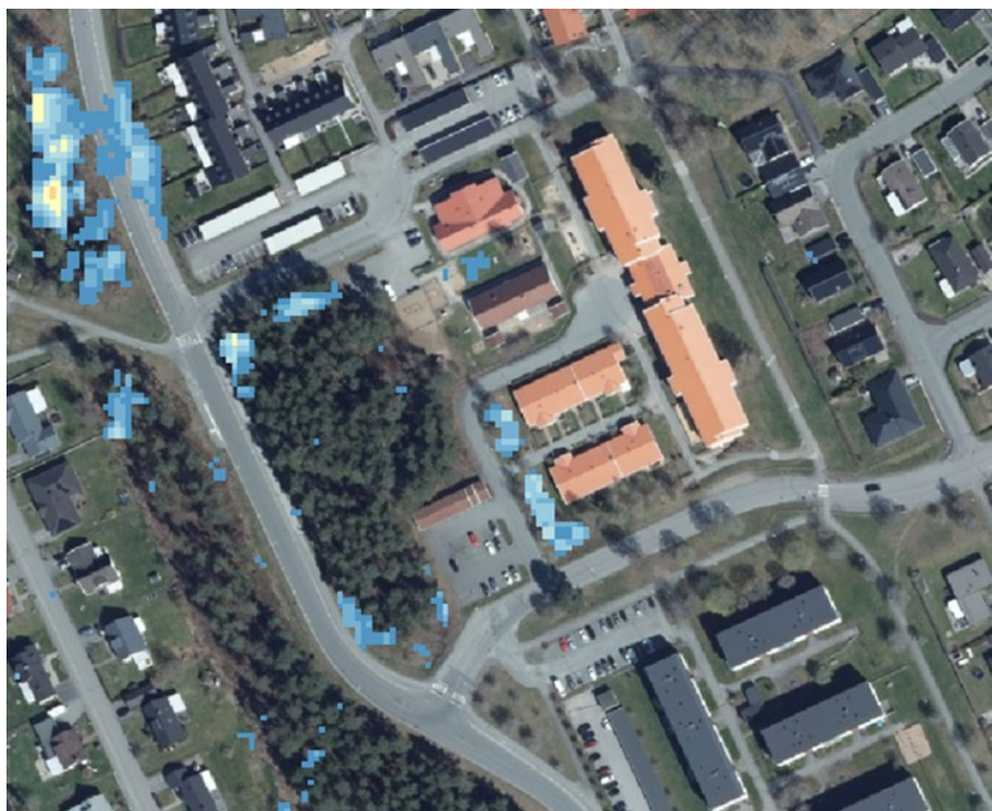
Utdrag av Skyfallskartering utförd av WSP 2022 som visar vattendjup efter 10 h
