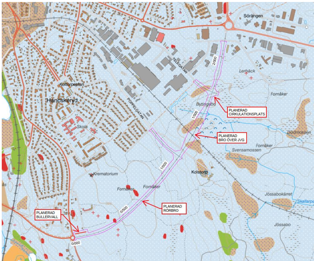
Figur 8. Utdrag ur SGU:s översiktliga jordartskarta. Gråblått område med vita prickar avser sandmorän, röda områden avser ytnära berg, bruna områden avser torv.
