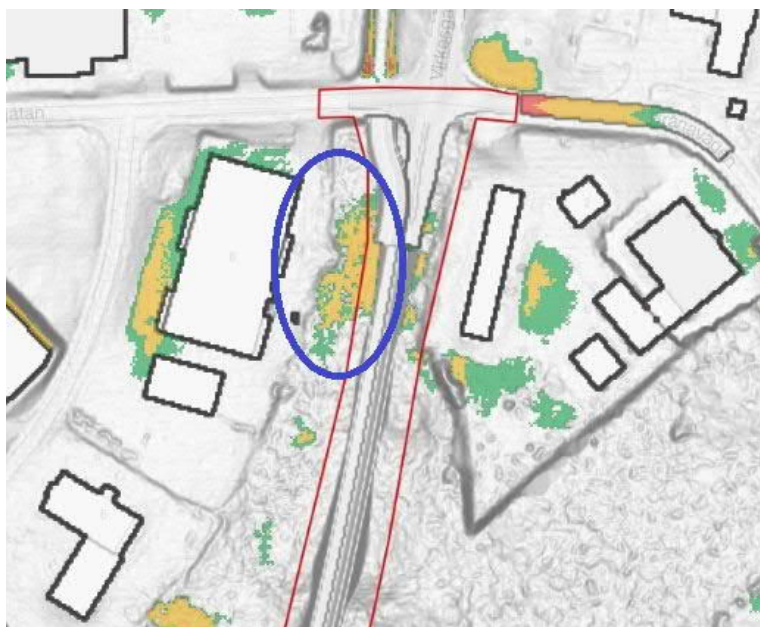
Figur 32. Simulering av större översvämning med 150mm nederbörd i Scalgo Live. Det simuleras att det inte finns någon passage för vattnet genom vägområdet. Det uppstår då en större yta som översvämmas (blå markering), med nuvarande höjdsättning översvämmas ingen infrastruktur eller byggnader. Med passage genom vägen kan översvämningen bli mindre. Grön färg är upp till 10cm vattendjup, gul färg 10-30cm och röd färg vattendjup över 50cm. Röd avgränsning utgör planområdet.
