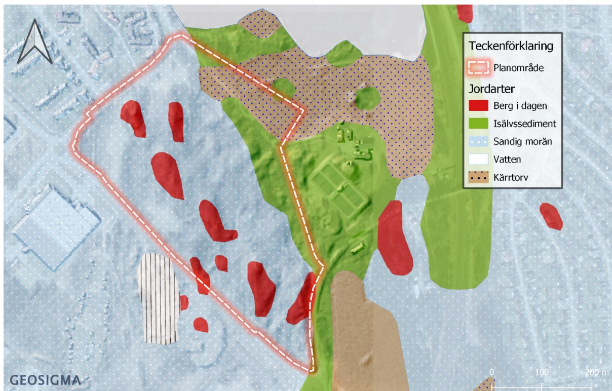
Figur 3-5. Jordartskartan från SGU visar att planområdet (röd streckad polygon) bedöms bestå av sandig morän, berg i dagen, isälvs sediment och kärrtorv.
